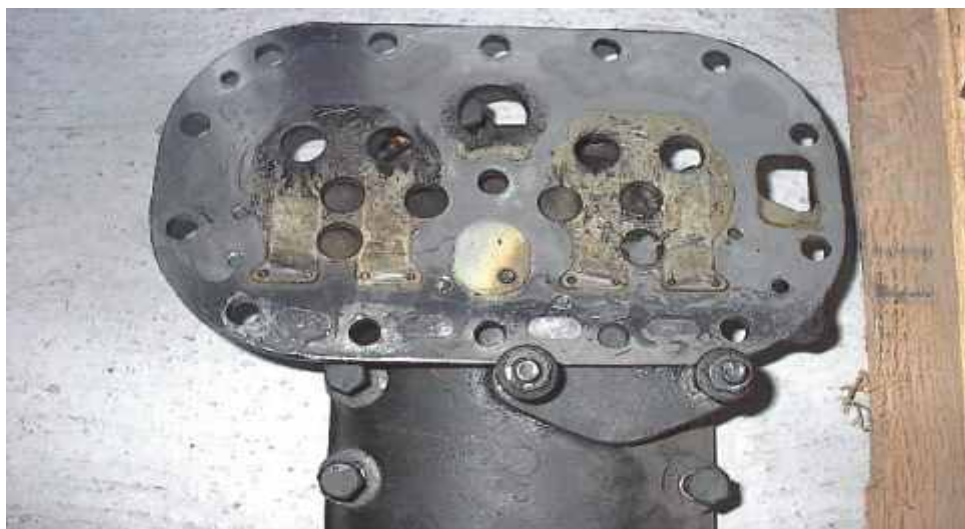
Figura 7.3. - Plato de válvulas con un sobrecalentamiento
