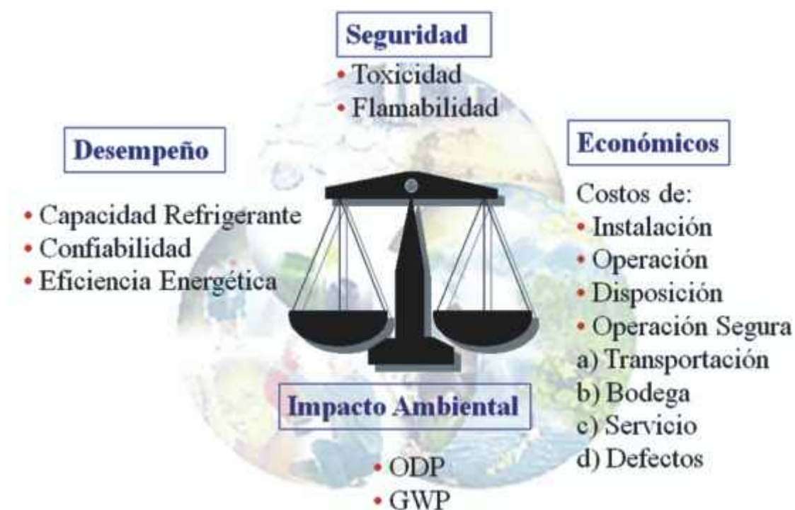
Fig. 5.1.- Factores a considerar en la elección de un refrigerante
